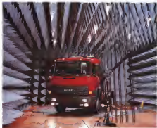
Foto 3 - Sala «Galileo Ferraris» di qualificazione dei sistemi elettronici di bordo sulvece le vanifiche dell'Università del Piemonte in campo elettromagnetico: ogni quarto gennaio del mese con TV, per il radio, radar o ma ha un'alta frequenza e livello da ricerca. Il sistema di gestione tramite un'elaborazione passo nella stanza conosci.
